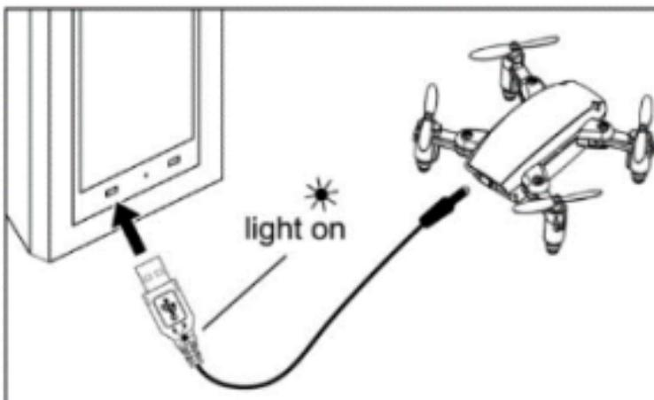
2. Na ongeveer 60 minuten opladen gaat het oplaadlampje uit als het vol is.
