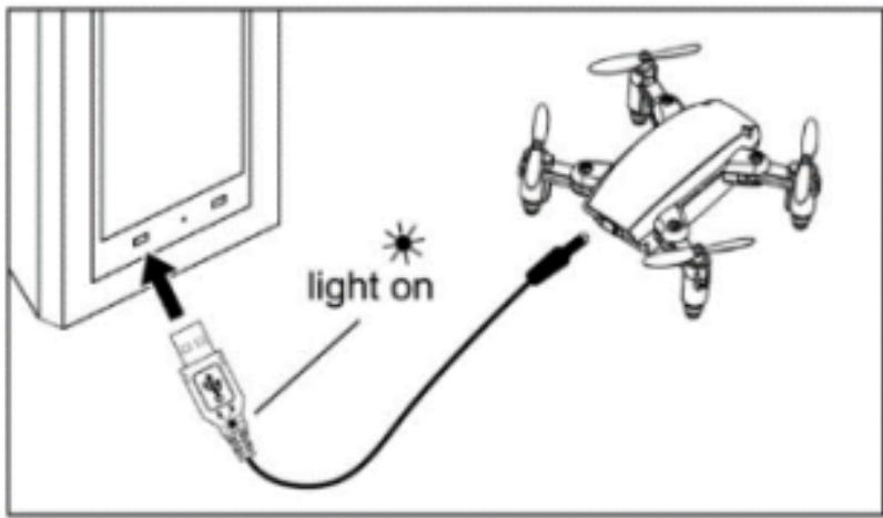
2. Nach ca. 60 Minuten ist das Gerät vollständig geladen. Die Anzeigeleuchte erlischt.
