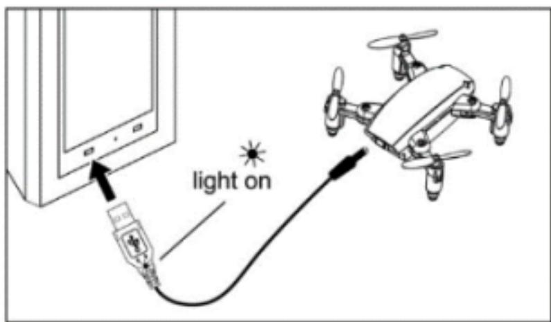
2. Transcurridos 60 minutos de carga, la batería ya está cargada y el indicador LED se apaga.
